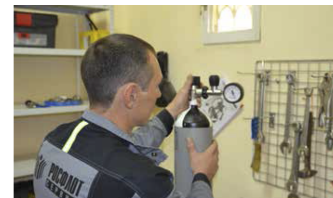
Проверка воздушных баллонов
